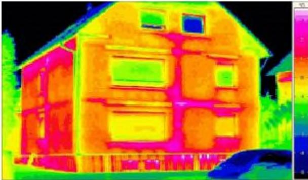
*Um den Wärmeverlust bei Häusern sichtbar zu machen, verwendet man heute „Wärmebildkameras“. Dort, wo das Bild rot ist und pinkfarbene Stellen zeigt, geht im Winter die Wärme und somit die Energie verloren!*
